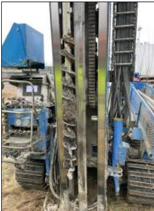
Figur 9. Jordskruv från provpunkt 24PE06 0–1,0 m u my. Jordlager utgörs av fyllnadsmaterial i form av något mullhaltig, stenig grusig sand med inslag av tegel.
