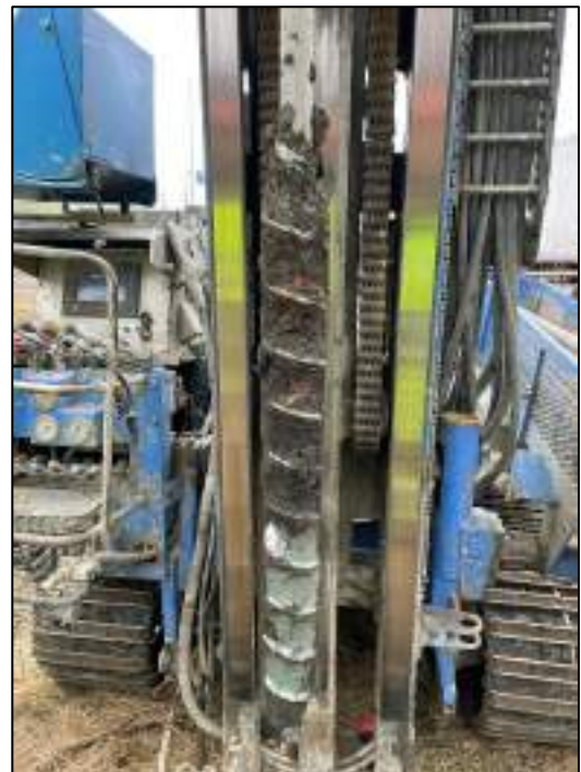
Figur 10. Jordskruv från provpunkt 24PE06 1,0–2,0 m u my. Fyllnadsmaterialet fortsätter ned till 1,7 m och utgörs av grusig sandig mull med inslag av tegel. Fyllnadsmaterialet underlagras av torrskorpelera.
